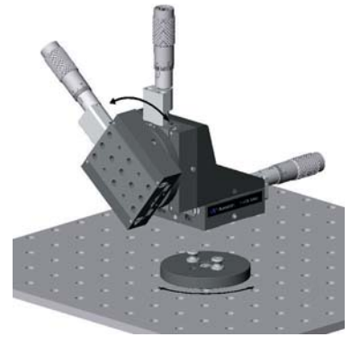
回転アダプタを使用してステージを任意の角度へ回転し、所定の位置でロックします。
