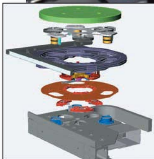
▲ Dynam YX GTエアベアリングステージと組立品を組み込んだZT3
