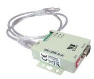
CONEX-USB-RS422コンバータを経由すればCONEX-LDS をイーサネット通信またはUSBを利用して使用できます。
