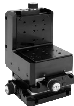
VP-25Xステージは、オプションのVP-BKブラケットによってXYZ構造内に簡単に取り付けることができます。この図は、左手系の (M-) VP-25X-XYZLです。
