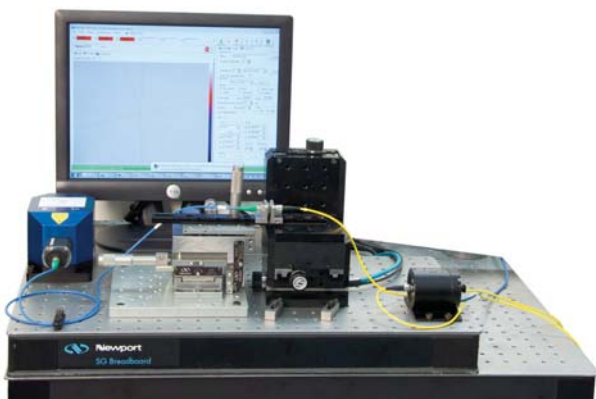
VP25XL-XYZRシングルモードファイバライメントのセットアップ
