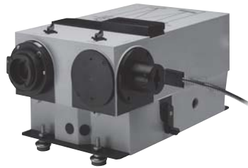
77200 Oriel®モノクロメータに接続した長方形-円形ファイババンドル
