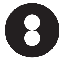
図3 2分岐型リキッドライトガイドの共通端側正面図。この端部は、単一の円形コアになるように結合しているわけではありません。
