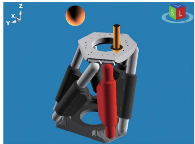
負荷、力、トルクを使用したパフォーマンス試験 (最悪シナリオのポジションの特定に便利です)
