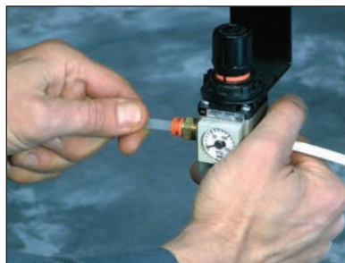
最後に、一体型レベル調整脚と気泡管水準器を使用してフレームのレベルを調整し、実装済みのARFに空気供給のためのプラグを接続します。
