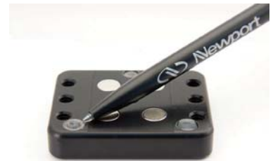
「円錐型」、「V溝型」および「平坦型」は、キネマティック機構を作成する上で重要な要素となります。すべての機能はCPPシリーズのカーバイドパッドを通じて提供されます。
